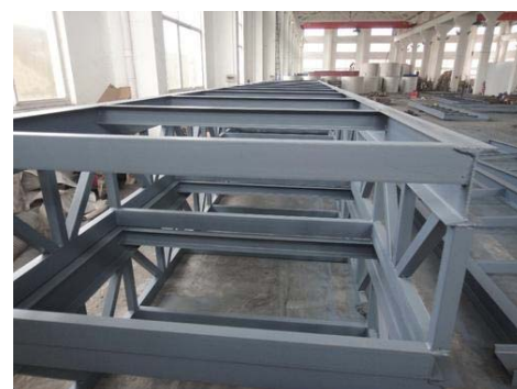
配管サポート
